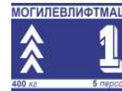
Табло ТИГ - монохромный ЖКИ с вариантами голосового информирования. Отображает, грузоподъемность, номер этажа, направление движения, сообщение о перегрузке.
